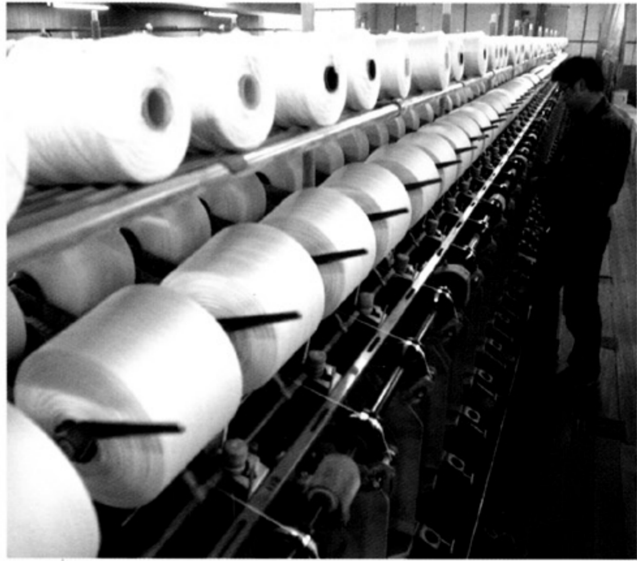
幅約20メートルの燃糸機が絶え間なく稼働する工場。綿糸や和紙をより合わせて強度を高める
